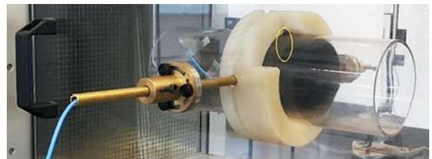
Figura 8 (b). Detalhe do sensor montado num tubo de acrílico dentro da câmara de teste (a elipse amarela mostra a posição do sensor dentro do tubo).
