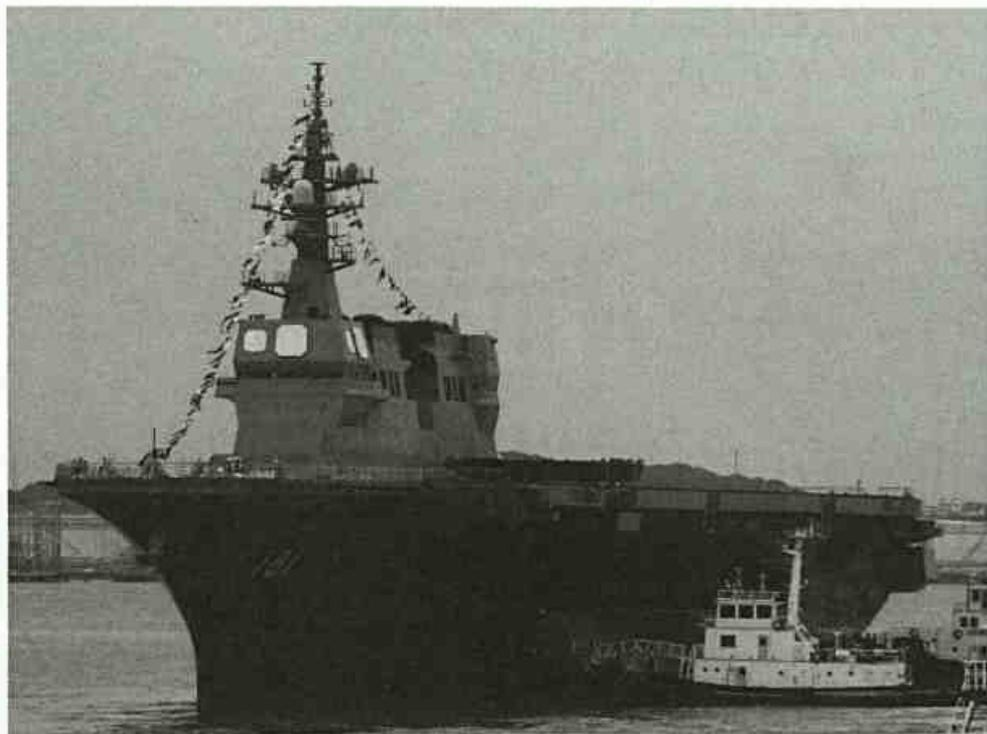
comprimento total, 32 m de boca máxima, 22 m de pontal e 7 m de calado carregado. Por razões políticas e legais, foi mantida a designação DDH para esta classe de belonaves.<sup>3</sup>
