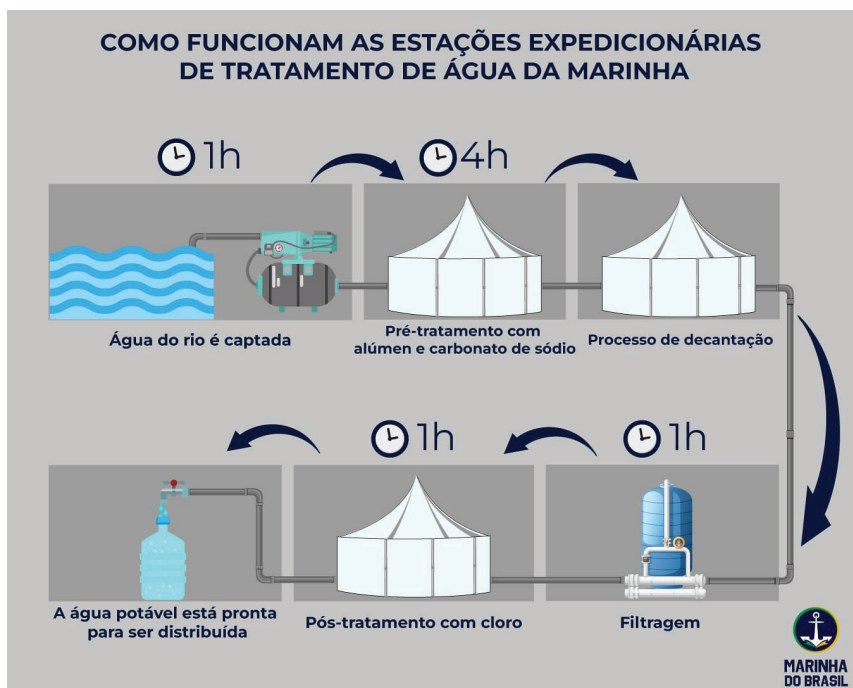
Funcionamento de uma estação expedicionária de tratamento de água
