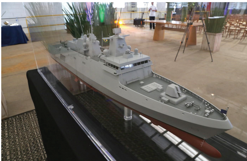
Figura 4 – Maquete com detalhes do canhão 76/62, míssil Sea Ceptor e radar de busca volumétrica
