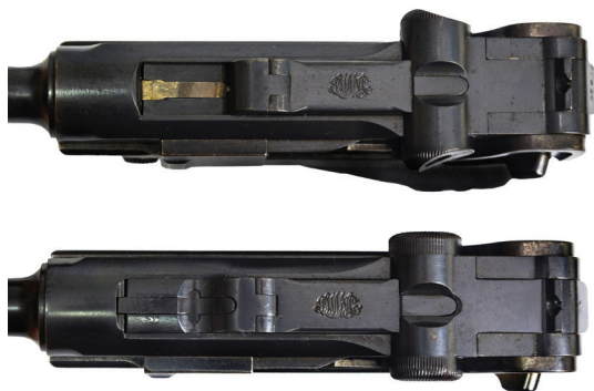
Figura 12 – Imagem que retrata claramente a diferença no desenho do ferrolho das pistolas do “modelo antigo” (acima) em relação ao “modelo novo” (embaixo). Além da manopla de acionamento (as “orelhas”) note o formato distinto do extrator e da parte posterior do ferrolho, mais arredondado no modelo novo. (Acervo particular, foto do autor)
