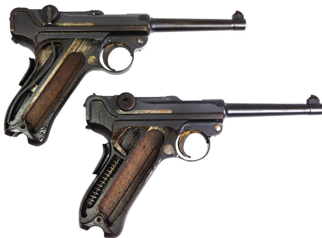
Figura 11 – Exemplar do “modelo antigo”, igual ao da Marinha brasileira (acima), comparado ao “modelo novo” (embaixo), evidenciando o tipo diferente de mola de recuperação, situada na empunhadura (Acervo particular, foto do autor)
