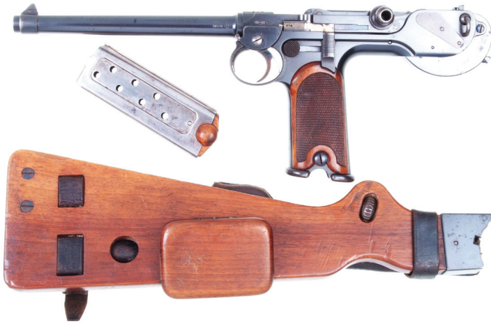
Figura 1 – Pistola Borchardt C.93. Produzida entre 1893 e 1897, foi a primeira arma de seu tipo a ser produzida em escala comercial. Testada por diversas forças armadas, se mostrou inadequada para uso militar, mas serviu de base para a Parabellum. (Acervo particular, foto do autor)
