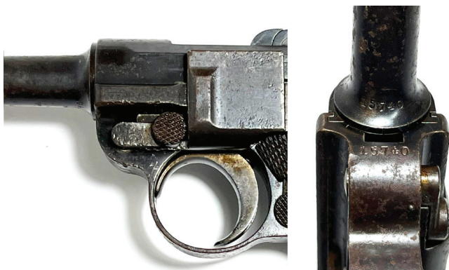
Figura 15 – Detalhe do exemplar nº 15.740, onde fica evidente a ausência dos bancos de prova. A mesma característica é observada nos dois outros exemplares fotografados para o artigo. (Acervo DPHDM)
