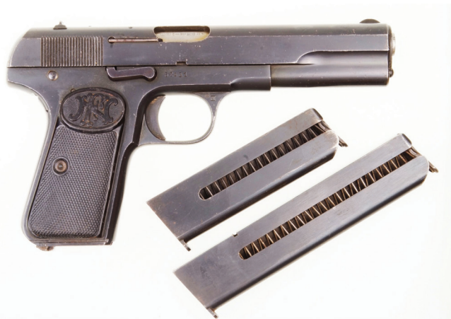
Figura 10 – A pistola FN Browning Modelo 1903, calibre 9 mm Browning Long (9 x 21). Essa pistola foi testada extensamente pela Marinha entre 1908 e 1909 (Acervo particular, foto do autor)
