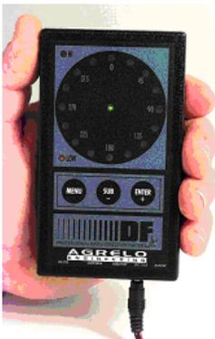
Modelo de um equipamento que mostra a direção da fonte transmissora do sinal
