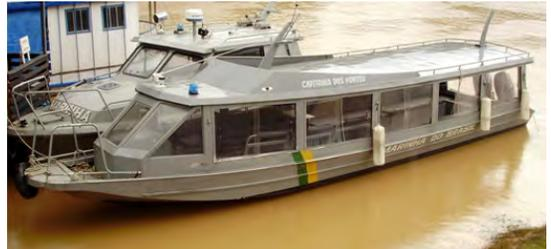
A nova lancha, construída em casco de alumínio, mede 12 metros de comprimento, possui dois motores de popa de 115 HP e atinge a velocidade de 40 nós. A sua autonomia é de oito horas e tem capacidade para transportar 20 militares.
