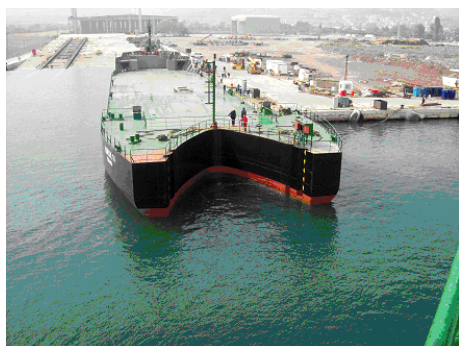
Vista geral de uma barcaça não tripulada e seu vértice de acoplamento
