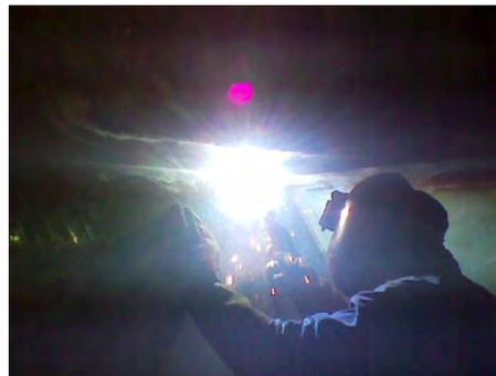
Fig. 2 – Soldador gerando contaminantes no processo de soldagem
