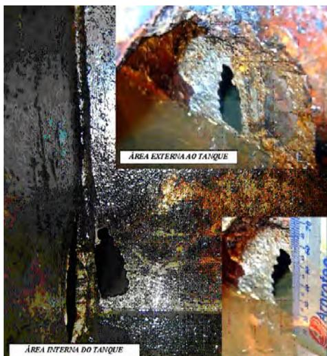
Figura 5. Furo no tanque de serviço de BE visto internamente e externamente
