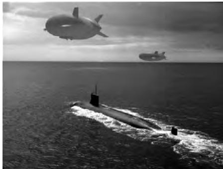
Na década de 1980, o *blimp* Airship 500 foi testado pela Guarda Costeira americana, pela França e pelo Reino Unido para patrulha marítima. O estudo Pace (Patrol Airship Concept Evaluation), realizado em 1983 pela Guarda Costeira americana, mostrou a vantagem dos *blimp* quando comparados com as aeronaves. Queriam uma aeronave para seis tripulantes com autonomia de 48 horas. O programa foi cancelado em favor de um projeto de *blimp* de vigilância da US Navy.
