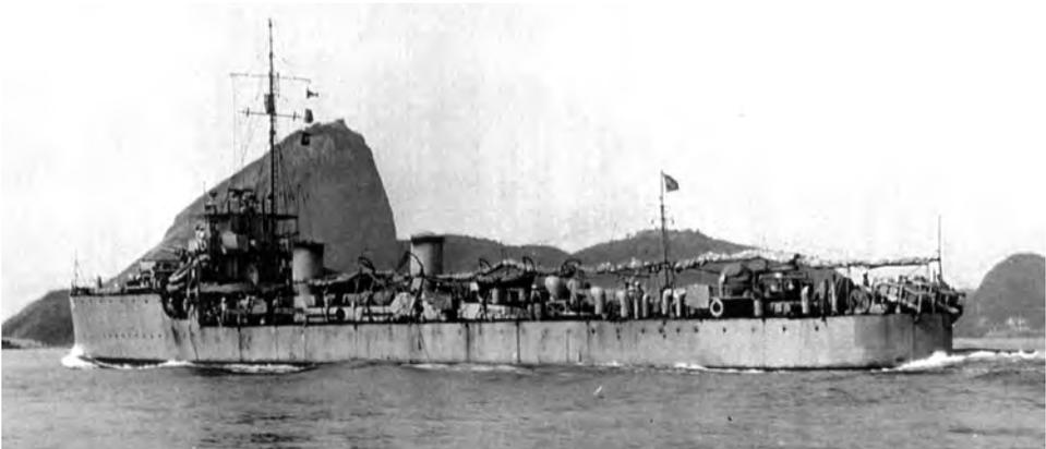
Contratorpedeiro *Mato Grosso*. Observar a calha de bombas de profundidade
