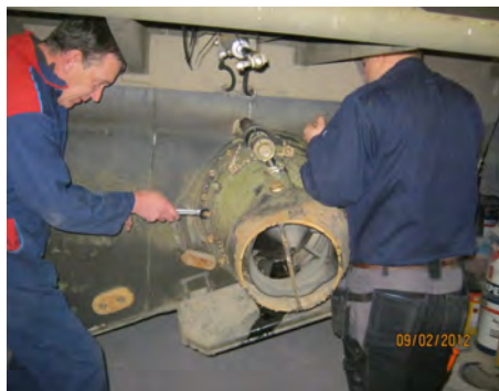
Desmontagem do sistema de propulsão a hidrojato
