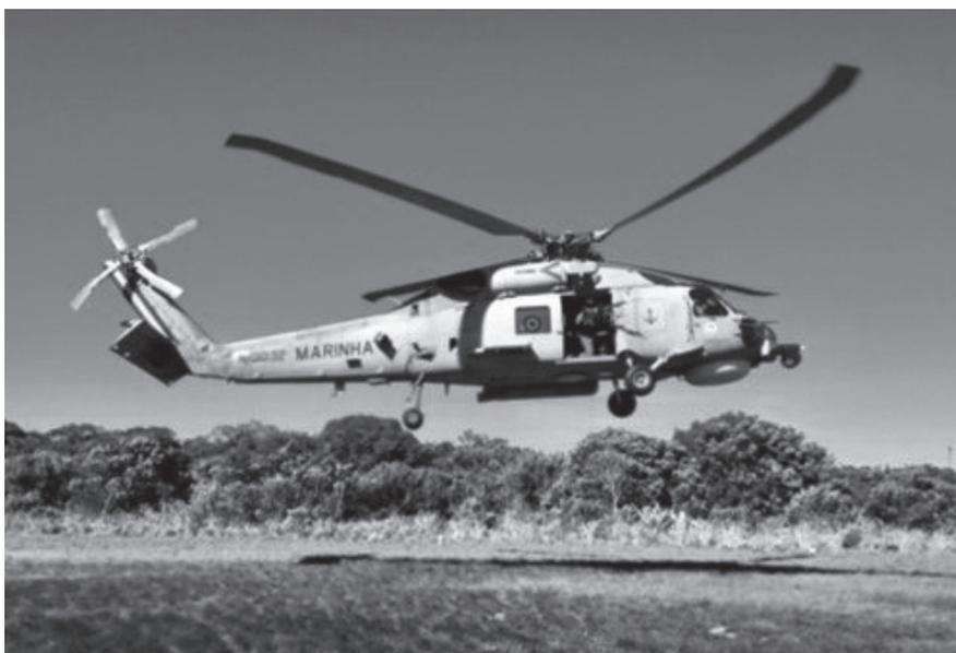
Aeronave SH-16 Seahawk armada com metralhadora lateral MAG 7,62 mm
