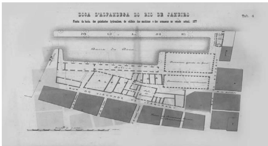
Figura 2 – “Doca d’Alfândega do Rio de Janeiro: Planta representando a bacia, os novos guindastes hidráulicos e edificio das machinas e os armazens projetados”
