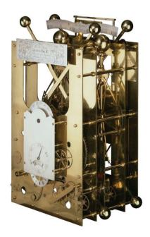
Figura 8 – Mecanismo interno do cronômetro naval H-2. Fonte: [9]
