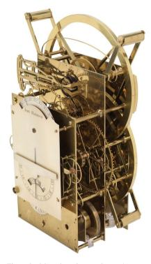
Figura 9 – Mecanismo interno do cronômetro naval H-3. Fonte: [10]
