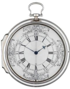
Figura 10 – Cronômetro naval H-4. Fonte: [11]
