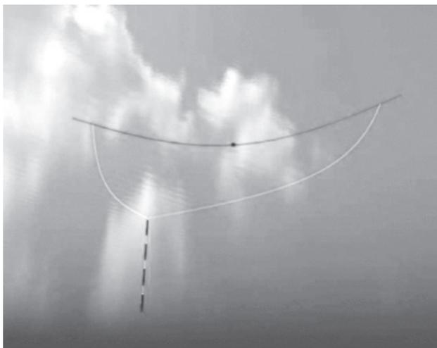
Figura 17 – Projeto de sistema de contenção com bolsões flutuantes e âncora
