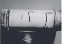
Figura 2 – Ensaio de líquido penetrante para detectar pequenas trincas Fonte: Souza (2017)
