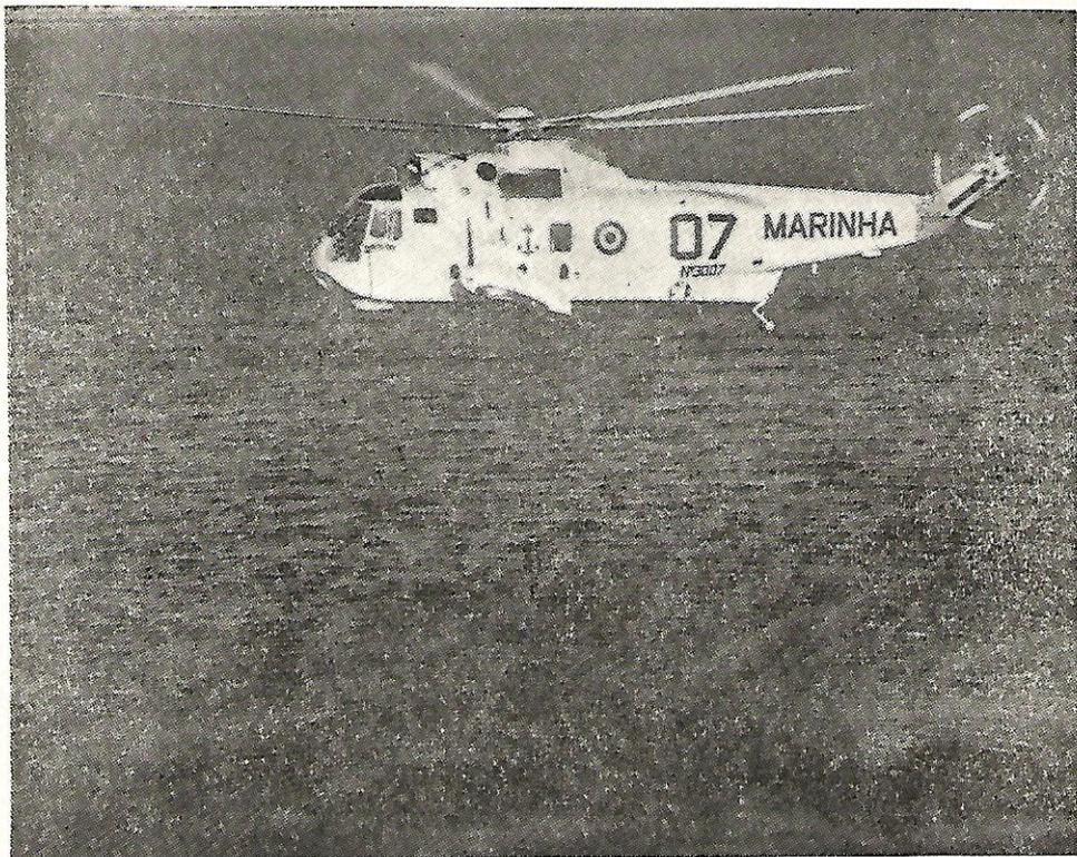
Existem algumas versões desse helicóptero fabricado pela Sikorsky, nos Estados Unidos, sendo a última o SH-3H, dotado de radar, sonobóias, equipamento de contramedidas eletrônicas, detector de anomalias magnéticas, além do sonar. Pretende-se dar a essa versão maiores tarefas de vigilância, quer submarinas, quer de superfície e aérea. No desenho que se segue pode-se ver a disposição dos sensores, equipamentos e armamento.
