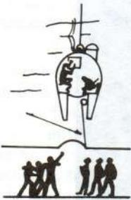
CÂMARA DE RESGATE DE PESSOAL AEROTRANSPORTÁVEL, QUE PODE ACOPLAR AOS 38 GUPPY E IKL. PARA ISSO NECESSITA DE UM CABO DE TRACÇÃO, PODE SER O DA BOIA QUE OS SUBMARINOS LIBERAM EM CASO DE NAUFRÁGIO, OU OUTRO A SER INSTALADO POR MERULHADORES. APÓS ACOPLAR À ÁREA AO REDOR DA ESCOTILHA, ESGOTA-SE A CÂMARA INFERIOR, QUE É ENTÃO COMUNICADA À ATMOSFERA...
