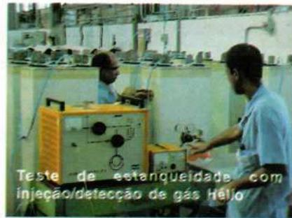
A integridade de vedação é confirmada inicialmente com ar sob pressão e no final com injeção de gás Hélio e sua detecção.
