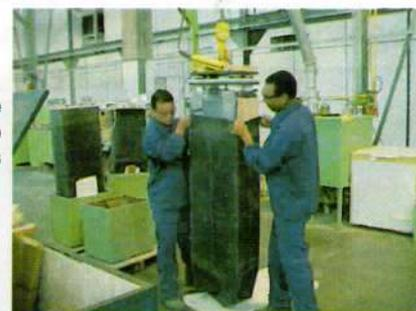
Colocação da bolsa de borracha sobre o conjunto de placas montadas
