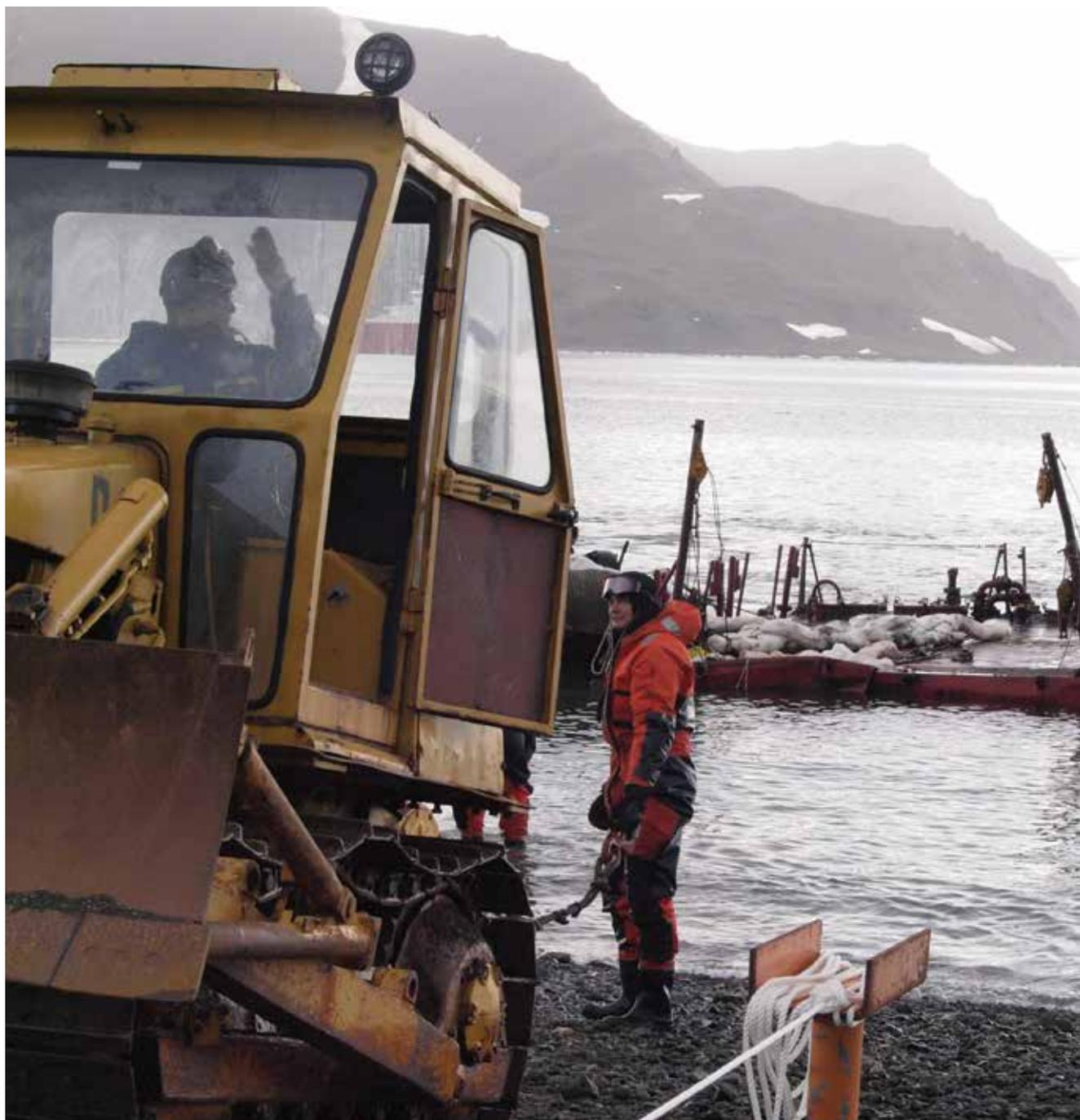
*Figura 3 - Trator D5 da EACF auxiliando o encalhe da chata.*
