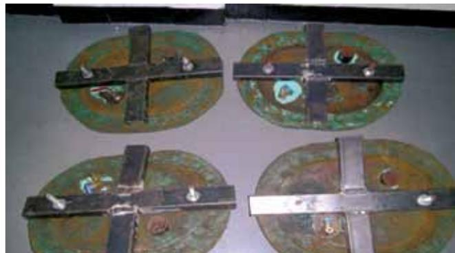
Figura 4 – Fase de confecção do travessão "Tipo X" e a visão dos elipses já com dispositivos prontos.
