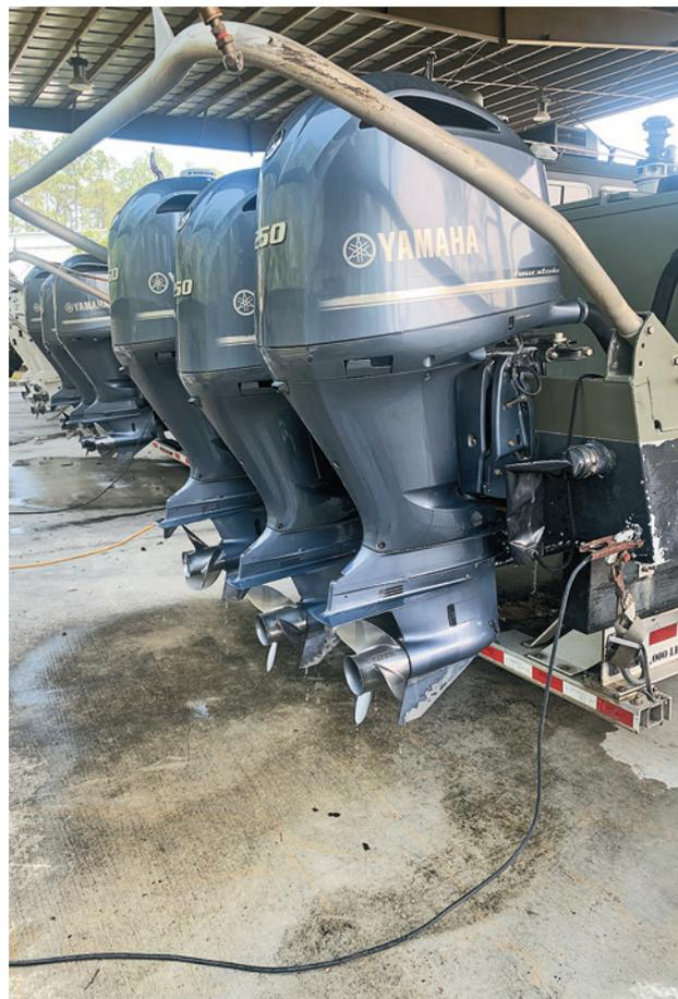
Figura 5: Motores Yamaha de 250 HP.
