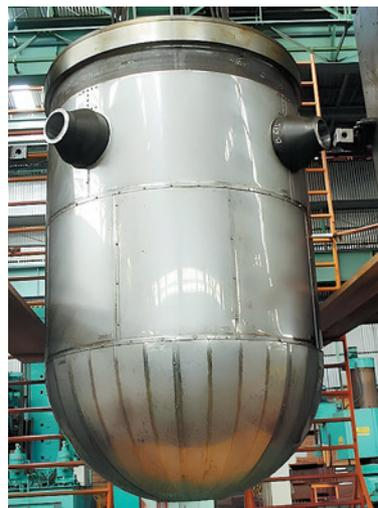
Figura 11: Vaso do reator do LABGENE. Fonte: Defesa Aérea & Naval. Disponível em: <https://www.defesaaereanaval.com.br/ciencia-e-tecnologia/nuclep-entrega-vaso-de-pressao-do-reator-do-labgene>. Acesso em: dez. 2024.
