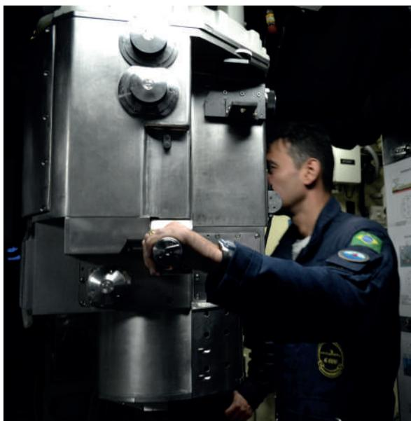
**Figura 5** – Detalhe do periscópio Carl Zeiss do SS Simpson
