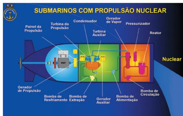
Figura 12: Esquema da propulsão nuclear. Fonte: *O Periscópio*. Disponível em: <https://www.portaldeperiodicos.marinha.mil.br/index.php/periscopio/article/view/1889/1885>. Acesso em: dez. 2024.
