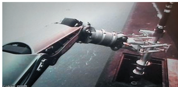
Figura 4: ROV (Conectando mangote de ar de alta pressão e transferindo POD).
