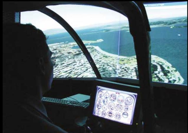
Simulador de voo montado na Escola Naval a partir de adaptações do Microsoft Flight Simulator 2004 e PC comercial adaptado
