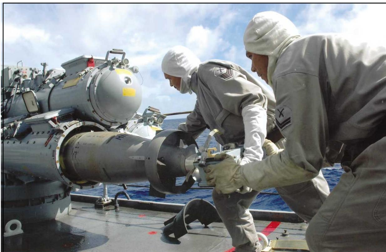
Carregamento de um torpedo Mk-46 mod 5 num dos tubos do reparo tripla STWS 2 de uma fragata classe Greenhalgh
