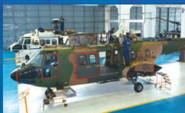
Inspeção “2 T” e “3 A” em aeronave CH-34 (SUPER PUMA) no Parque de Material Aeronáutico do Campo dos Afonsos.
