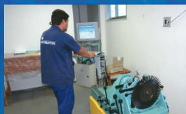
Máquina de balanceamento de eixos na sede da empresa.
