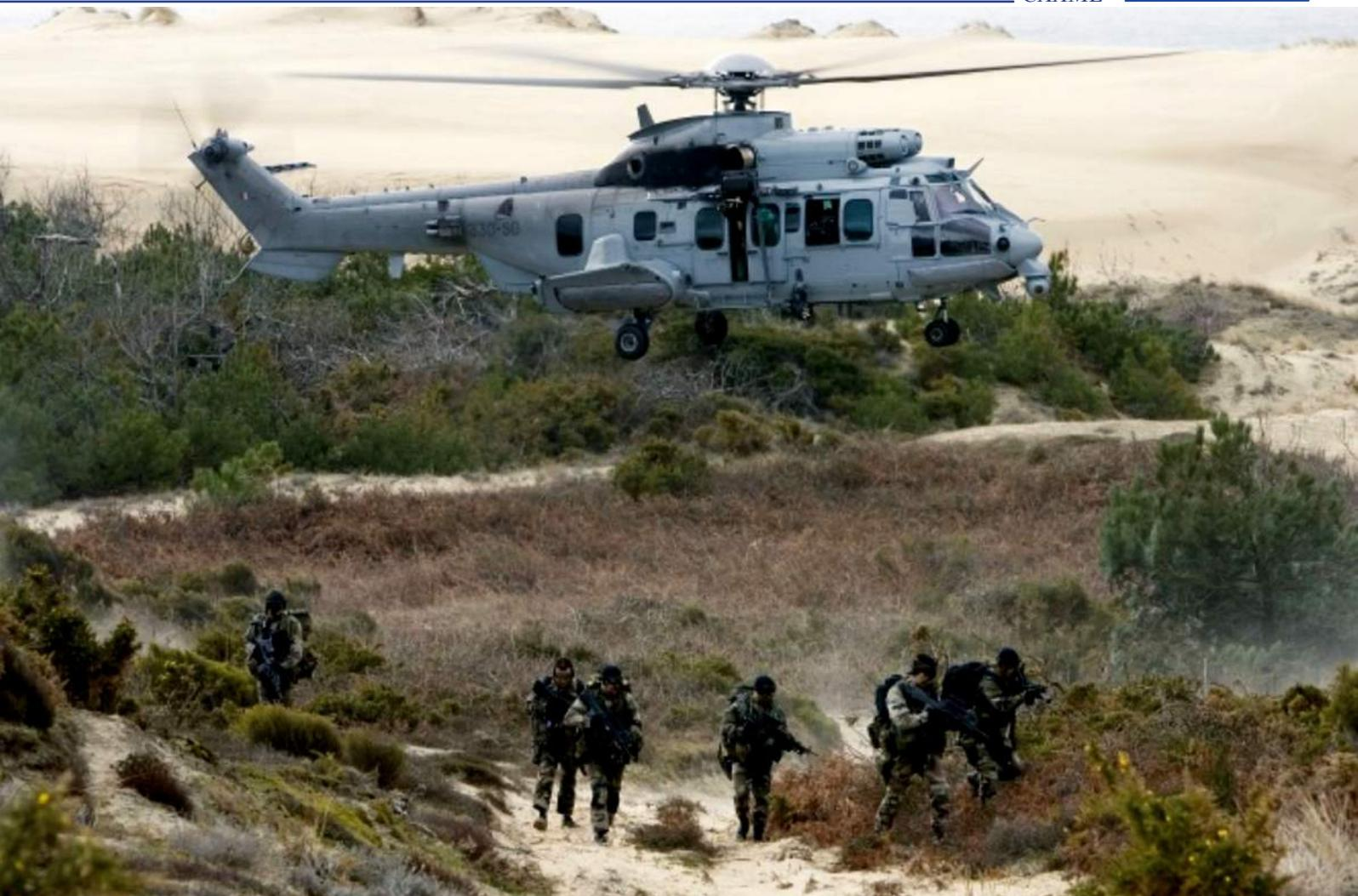
transporte de pessoal e carga limitada (transporta somente 03 fuzileiros navais equipados), pequena autonomia baseada na relação peso x combustível e, apesar de poder realizar voos noturnos, a não realização de voo por instrumento, mas sim em condições visuais, o que as deixam limitadas ao sobrevoo das proximidades da cidade de Manaus.
