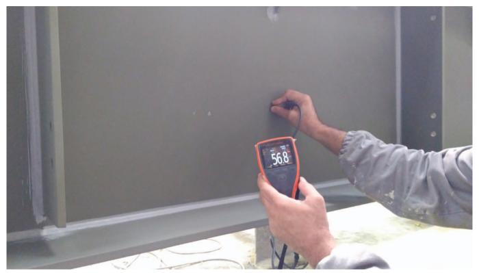
Medidor de espessura.
