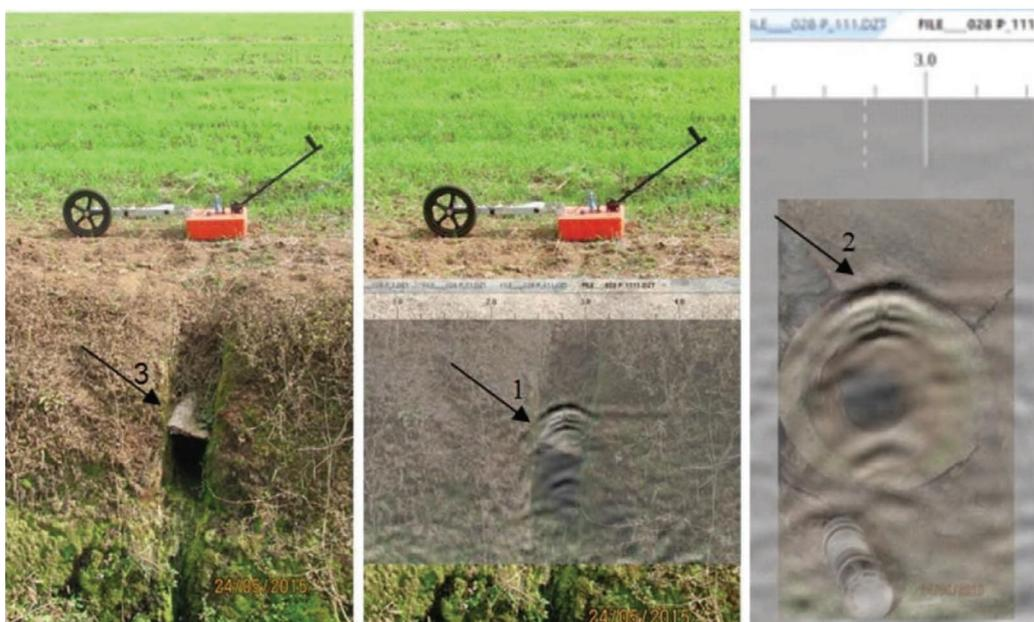
Figura 3 – Radargrama sobreposto indicando presença de manilha de concreto enterrada no terreno. Fonte: Machado et al (2016).
