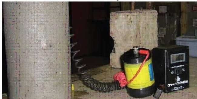
Figura 2 - Exemplo de equipamento utilizado para a determinação do potencial de corrosão (COURI, 2008).
