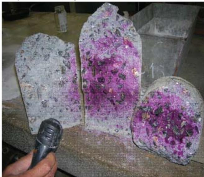
Figura 1 - Aplicação de solução indicadora em corpo de prova de concreto rompido, com a finalidade de demonstrar a diferença na coloração.
