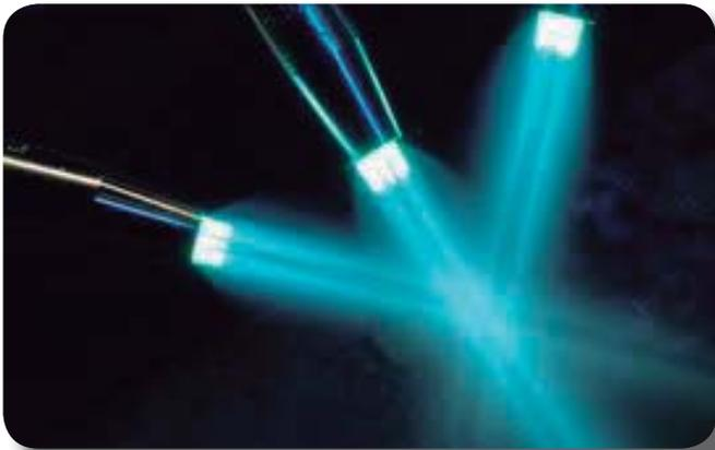
Figura 5 - Maçarico de Corte ( gases acetileno e oxigênio )
