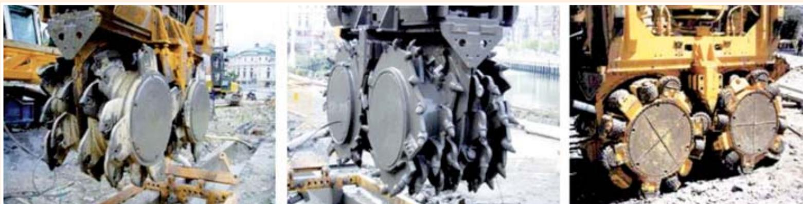
Figura 4 – Tipos de Rodas de corte da hidrofresa
