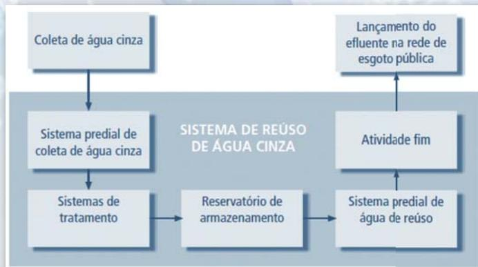
Figura 5 - Sistema de Reúso de Águas Cinzas.
