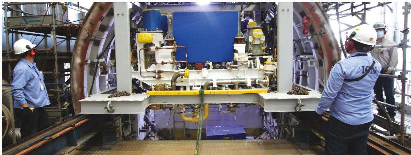
No dia 25 de junho, foi realizado o embarque da plataforma auxiliar de ré (*cradle*) no interior do Submarino “Tonelero”, nas instalações da Unidade de Fabricação de Estruturas Metálicas, em Itaguaí (RJ). A plataforma foi embarcada na Seção S2A do casco resistente, em cumprimento às metas de construção do terceiro submarino convencional.
