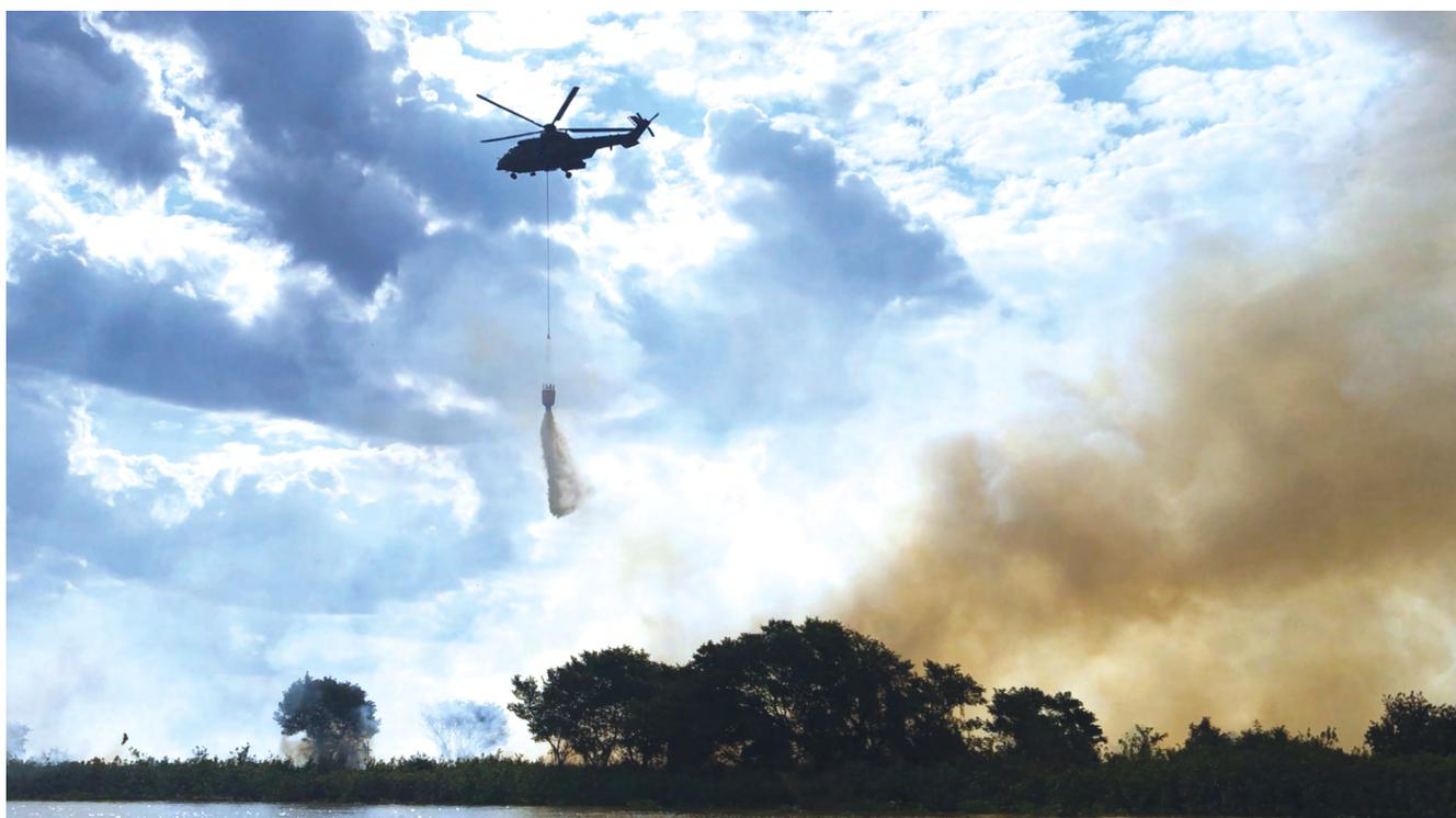
Marinha realizou inúmeras investidas com o *bambi bucket*, tipo de bolsa localizada na parte externa da aeronave capaz de transportar água até o foco de incêndio
