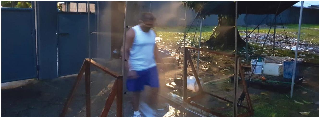
O 2º Batalhão de Operações Ribeirinhas (2ºBtlOpRib) concluiu, no dia 30 de abril, o desenvolvimento de um protótipo de borrifamento automático voltado para realizar a descontaminação diária dos militares e combater a proliferação do novo coronavírus. O mecanismo, de baixo custo, possibilita a desinfecção de pessoal e materiais, e poderá ser utilizado por diversos órgãos.
