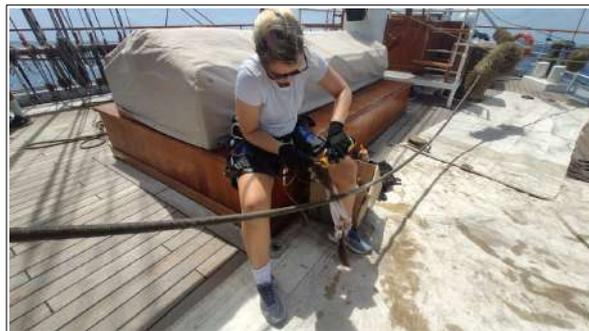
Foto: CC(CD) Luciana Freire em faina de lubrificação dos cabos de aço com óleo de alcátrão durante a atividade de manutenção denominada de "Descoberta" no Navio Veleiro Cisne Branco em 2024.
