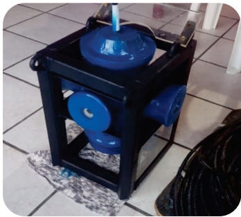
Equipamento com cinco câmeras e sensores oceanográficos para o levantamento da geobiodiversidade e características oceanográficas.
