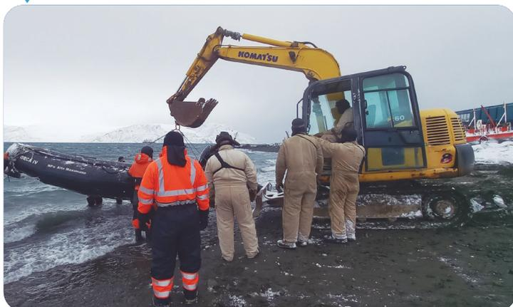
Facilita a remoção de rochas e solo em apoio às pesquisas, possui um gancho que possibilita o içamento para transporte de carga e remoção de equipamentos pesados dos botes.
