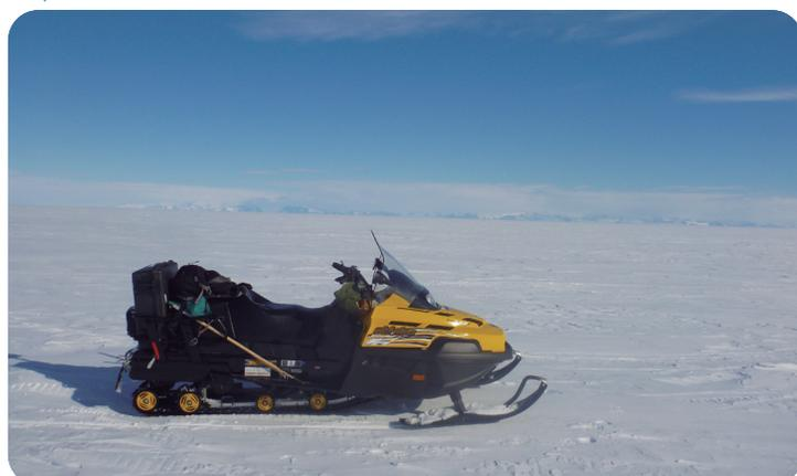
Para deslocamento de pessoal na neve, utilizado durante o inverno no recolhimento de carga lançada pelo voo de apoio, com esquis frontais e tração traseira por esteiras, transporta 30 kg, e reboca trenós com cargas até 500 kg.
