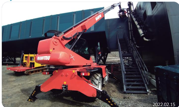
Veículo sobre rodas que proporciona a elevação de cargas e, utilizado em conjunto com a plataforma de trabalho elevatória, possibilita as atividades de manutenção em áreas elevadas da EACF.
