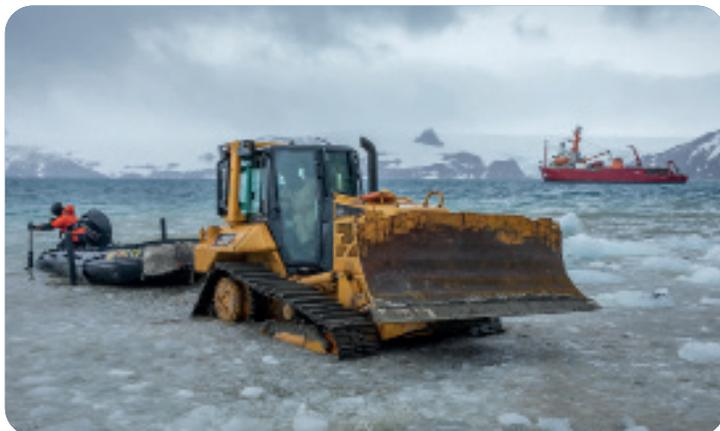
Com capacidade de carga de 15 toneladas, são utilizados nas manobras com as chatas de carga e de combustível, empurrando essas embarcações para o mar, e depois puxando-as para encalhe na praia. Dotados de esteiras e lâmina dianteira articulada, movimentam grandes volumes sobre skid, como contêineres de 20 pés. Também auxiliam na remoção de neve do terreno, para facilitar o deslocamento do pessoal e de outras viaturas.
