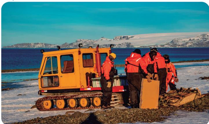
Para transporte de carga em terreno coberto por neve e gelo, utilizado para o transporte dos paletes de carga lançados nas operações aéreas durante o inverno. Transporta até 5 passageiros, com capacidade de carga de 3.120kg e reboque de 2 até toneladas.
