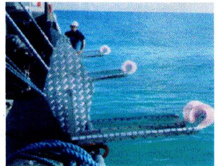
Detalhe do equipamento lançador e recolbedor de espinhel de anzóis
