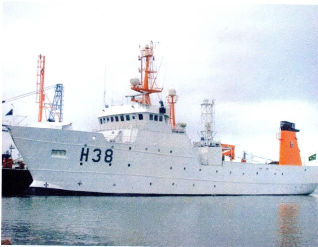
hidrográfico e uma estação meteorológica automática. Possui também certificado de segurança para navegação em águas polares de condição “light ice”, desde que seu calado a vante seja superior a 3,5m.
