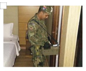
Figura 5: Detector e Identificador radiológico Spir Id
