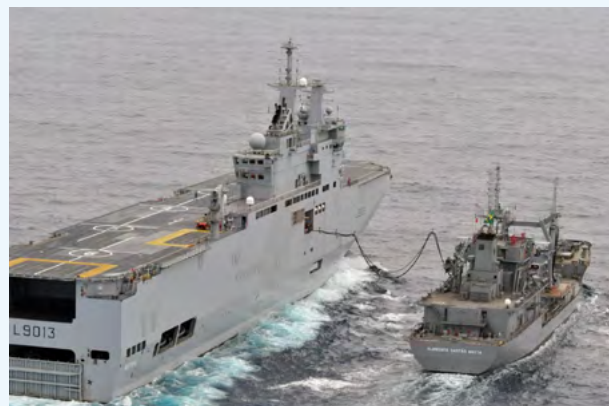
Navio-Tanque “Almirante Gastão Motta” durante transferência de combustível em alto-mar para o Navio-Anfíbio “Mistral”, da Marinha francesa
