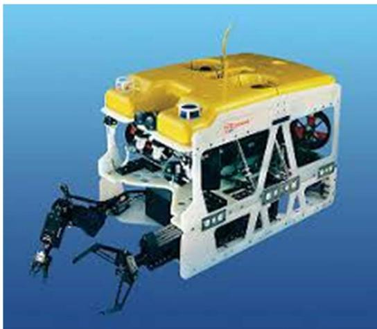
FIGURA 2 - Veículo de Operação Remota de Intervenção ou *Intervention Remotely Operated Vehicle* (iROV). Fonte: disponível em: <<http://www.underwaterengineering.net>>
