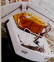
A lancha hidrográfica é mantida disparada, a meia talha ou na água, pronta para largar
