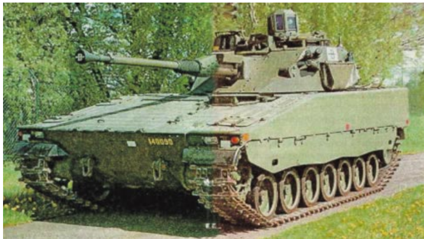
Carro de Combate CV9040A com o aparelho de pontaria Lemur (o lançador MAC Bill, montado à direita da torreta, não está visível)
