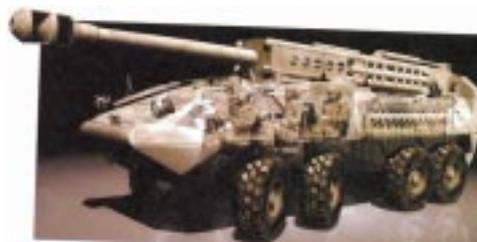
De modo a ampliar a capacidade de deslocamento através campo desse obuseiro autopropulsado, ele será dotado de um sistema capaz de controlar, do interior da viatura, a pressão dos seus pneus. Outra importante característica dessa arma é a possibilidade de ser aerotransportada em aeronaves C-130 Hércules e a facilidade com que poderá ser embarcada em meios de desembarque de Fuzileiros Navais.
