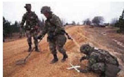
tros quadrados, o sistema RNQ detectou todos os engenhos em 15 minutos, enquanto o detetor de metais registou numerosos alarmes falsos em áreas sem minas, o que levaria a um tempo de detecção total de 7 horas.
