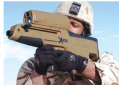
O XM-29 SABR, que seria parte do programa “Land Warrior”, congregava um fuzil derivado do HK G-36, um lançador de granadas de 25mm com munição inteligente, computador de tiro e lunetas especiais. Ao lado, o XM-25, que, como o XM-8, deriva do SABR. Notar o *layout bullpup* em um lançador de granadas, bem como a operação ambidestra.
