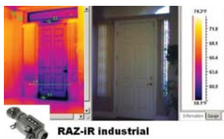
Figura 5 – Exemplo de imagem gerada por uma câmera termal comercial. Repare a dependência cor x temperatura, onde as áreas mais escuras estão relacionadas às áreas mais frias.
