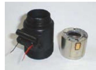
Figura 1b – Imagem de um elemento fotomultiplicador e sua placa de microcanais
