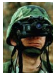
Figura 2a – Óculos AN-PVS-7D adaptado para capacete
