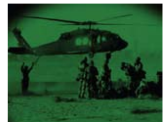
Figura 2b – Visão de EVN com tecnologia de amplificação de luz residual
