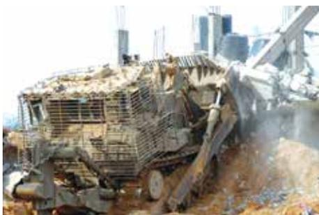
Figura 7: Trator D9 Caterpillar adaptado para o combate urbano
