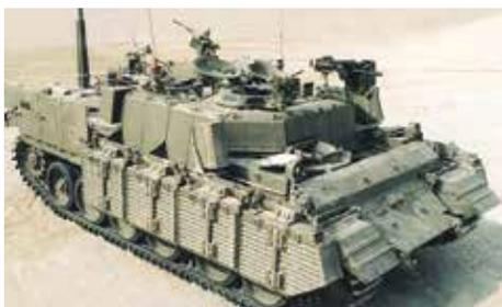
Figura 6: VBTP NAKPADON, readaptada para o combate urbano a partir do chassi de um antigo CC CENTURION do Exército Israelense
